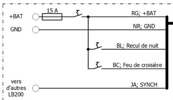
côté véhicule ; câbles qui ne sont pas nécessaires NON illustrés !
