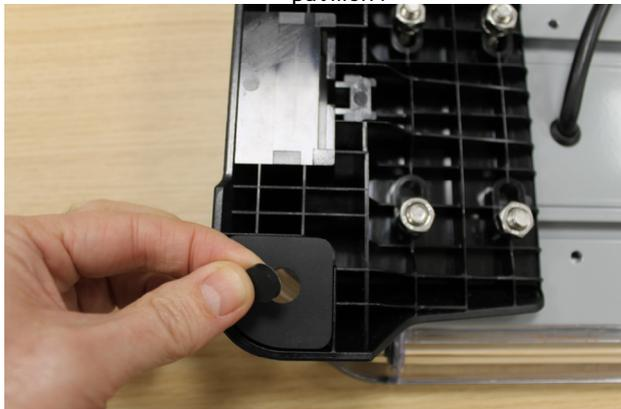
Une fois la rampe fixée sur le pavillon véhicule, poser les cache-vis
