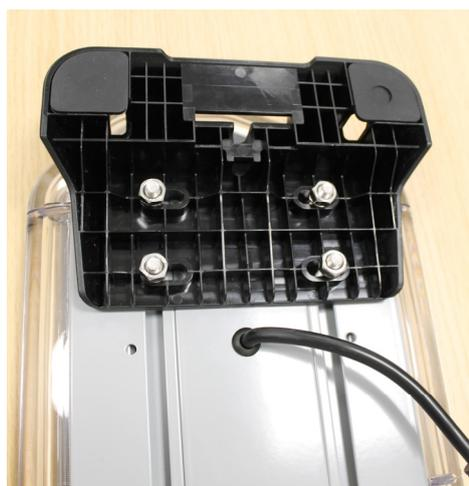
Utiliser du frein-filet et serrer les écrous.
