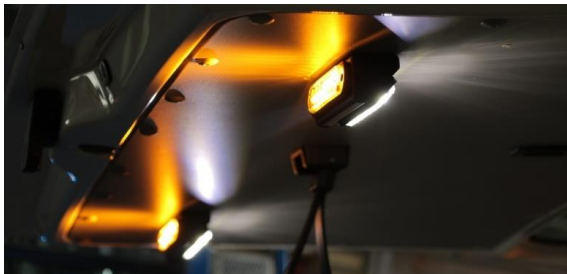
Beispielbilder L52 2C blau/gelb (Blaulichterweiterung und Heckwarnsystem) in Kombination mit einem L52 statisch weiß zur Ausleuchtung des Innenraums.
