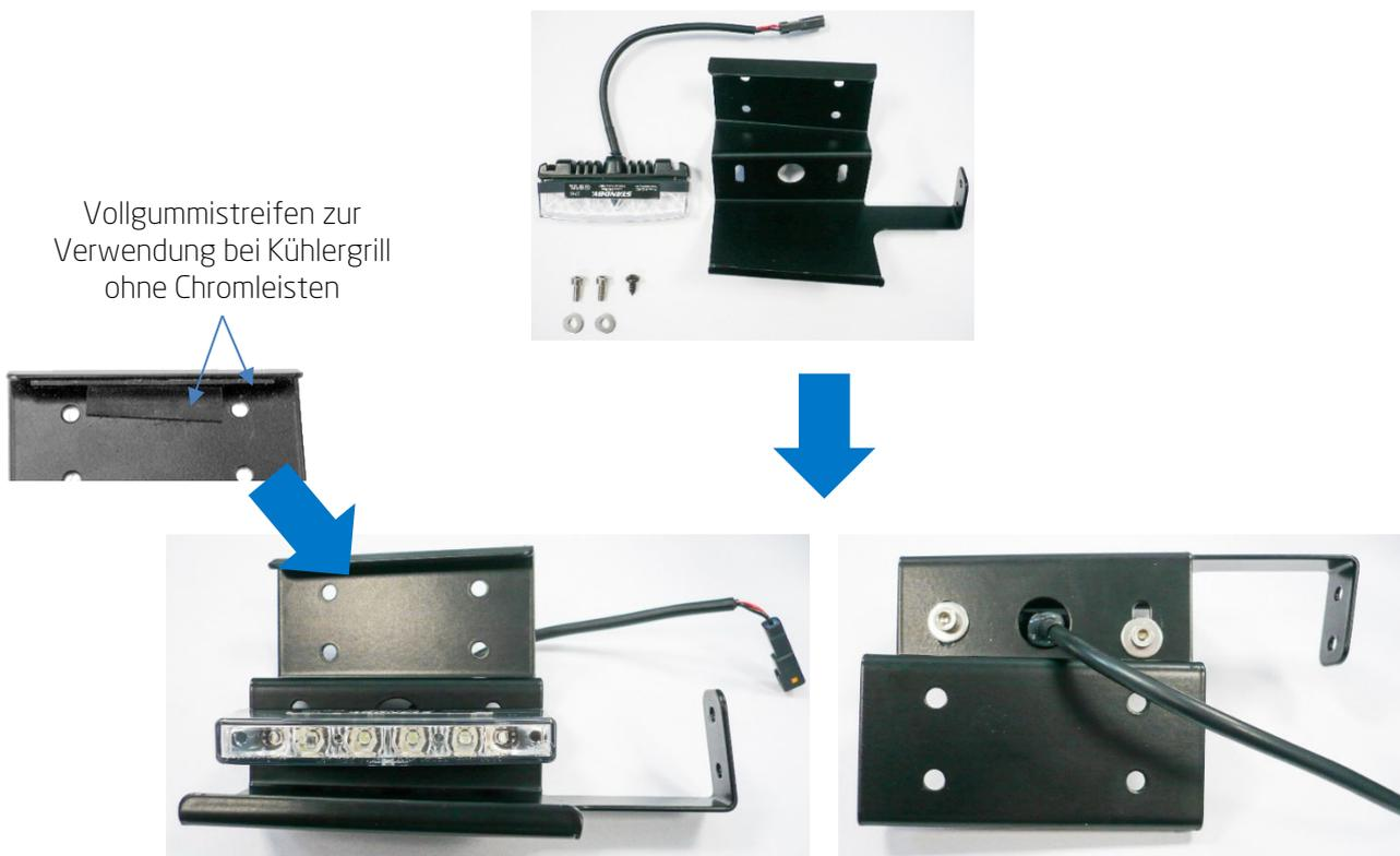
Das L54 Blitzmodul wie oben gezeigt vormontieren, die Befestigungsschrauben aber noch nicht festziehen. Dies geschieht erst nach dem Einbau des Halters in den Kühlergrill um das Blitzmodul final auszurichten.
