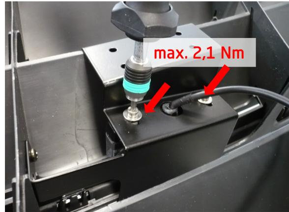
Das Anschlusskabel und der LED-Treiber kann an der Rückseite des Halters befestigt werden.
