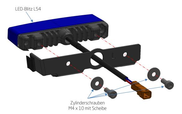
Das L54 Blitzmodul wie gezeigt vormontieren. Die Zylinderschrauben mit einem Drehmoment von 2Nm anziehen.
