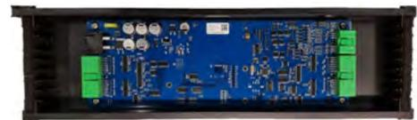
abgesetztes Steuergerät (Mainboard)
