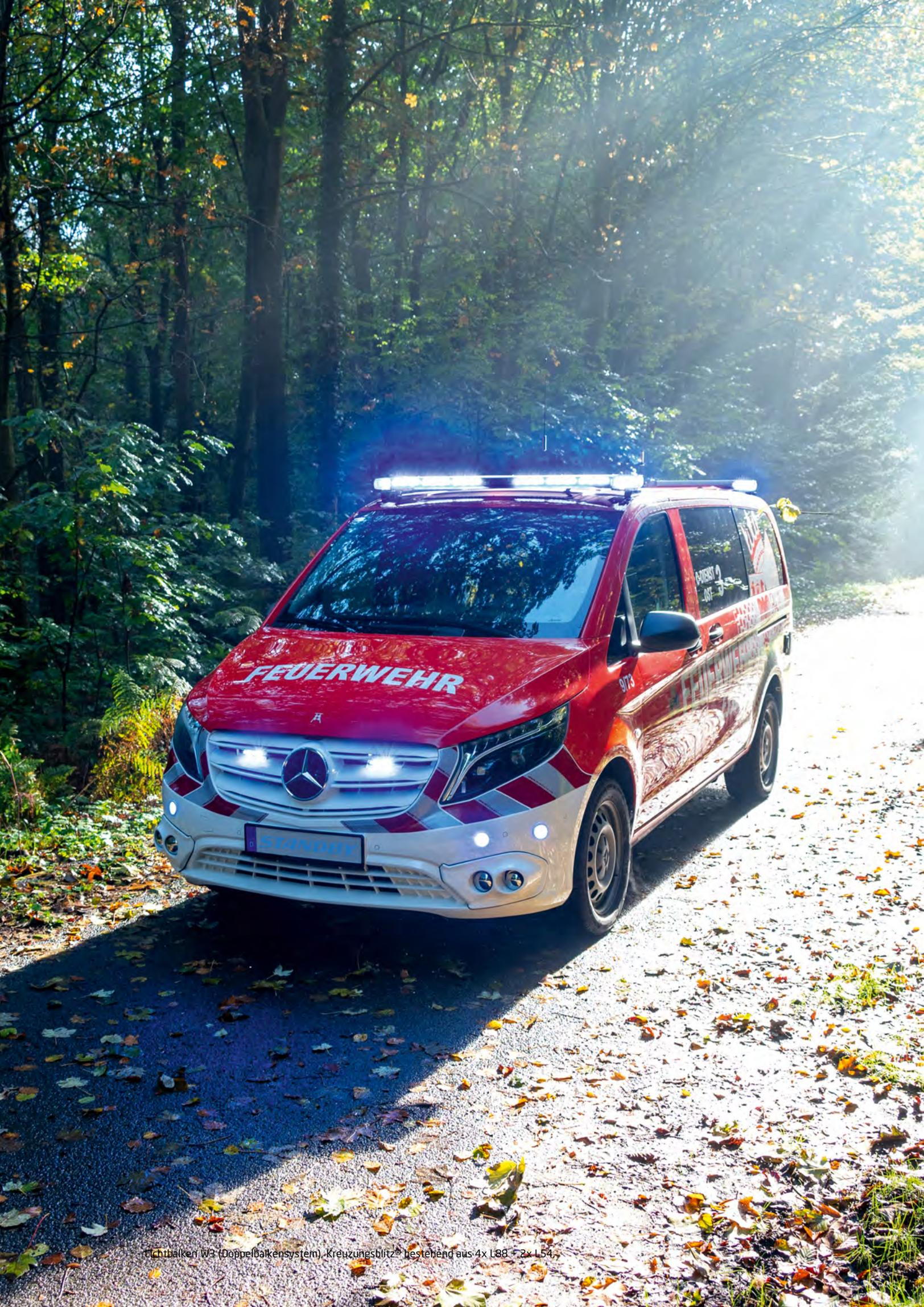
Lichtbalken W3 (Doppelbalkensystem), Kreuzungsblitz® bestehend aus 4x L88 + 2x L54
