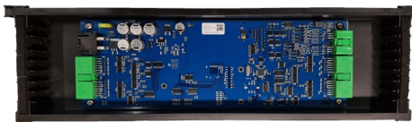
abgesetztes Steuergerät (Mainboard)
