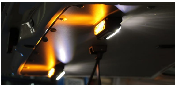
Beispielbilder L52 2C blau/gelb (Blaulichterweiterung und Heckwarnsystem) in Kombination mit einem L52 statisch weiß zur Ausleuchtung des Innenraums.
