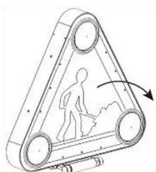
Ouvrir le panneau du Triangle en déposant les vis de fixation de celui-ci pour accéder à la centrale clignotante.
