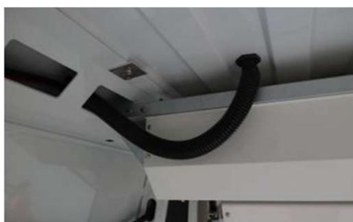
Le cheminement du faisceau électrique doit s'effectuer de préférence dans les montants intérieurs du véhicule.
