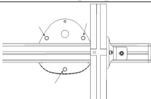
Position des vis de fixation (Platine de fixation du GYROLED vue de dessous)
