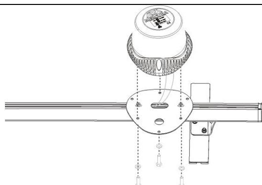
A l'aide des 3 vis HM06x16, fixer le GYROLED en appliquant du frein filet sur les pas de vis
