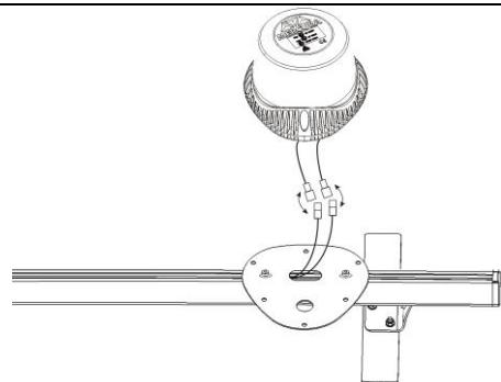
Connecter les GYROLED® M130 à l'aide de la documentation fournie avec ceux-ci afin d'identifier les fils à relier sur le faisceau de la rampe comme suit :
