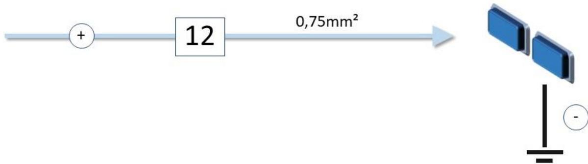
Il s'agit de fournir une commande d'alimentation « + BATTERIE » aux feux de pénétration. La masse de ceux-ci doit être reliée à une masse châssis identifiée ou un 0 volt batterie.
