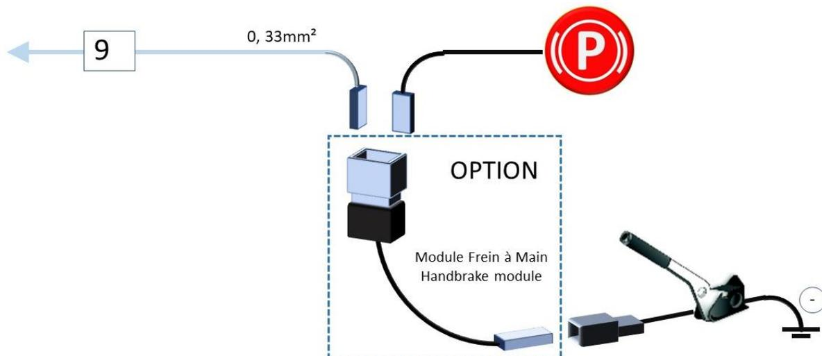
L'information frein à main serré est prélevée à travers un module frein à main qui permet d'envoyer une information de mise à la masse à la rampe lorsque le frein à main est serré sans perturber le circuit du voyant « Frein à Main » tableau de bord.
