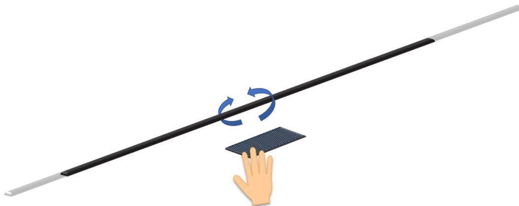
Décoller la pellicule de protection d'une des faces de l'adhésif fourni et coller celui-ci sur la face inférieure du câble plat.
