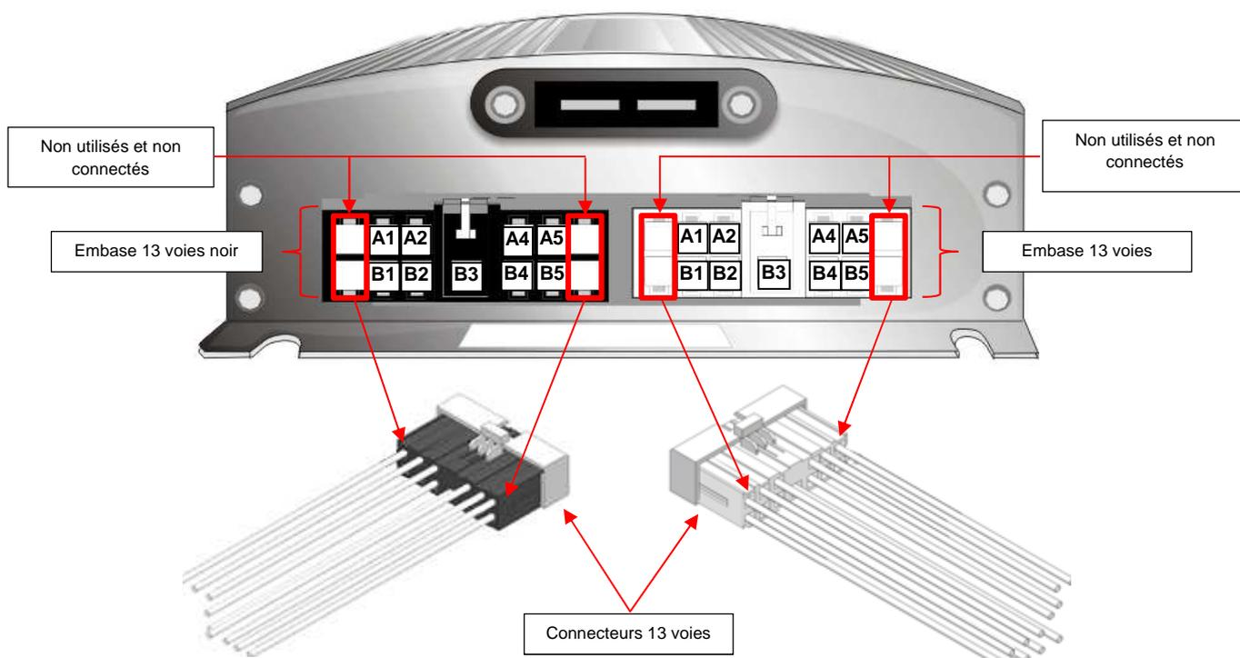
Pour insérer les connecteurs 13 voies dans les embases 13 voies.
