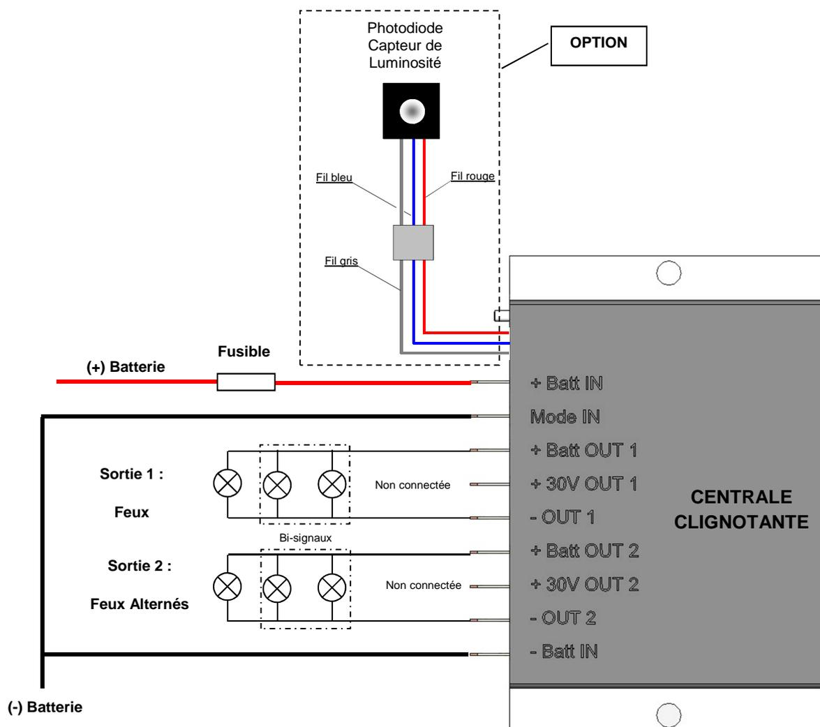
**MODE CLIGNOTANT :** La broche « MODE IN » est impérativement reliée au « - BATTERIE ». La sortie + Batt OUT 2 / - OUT 2 permet de connecter des feux en clignotement désynchronisé par rapport à la sortie +Batt OUT 1.
