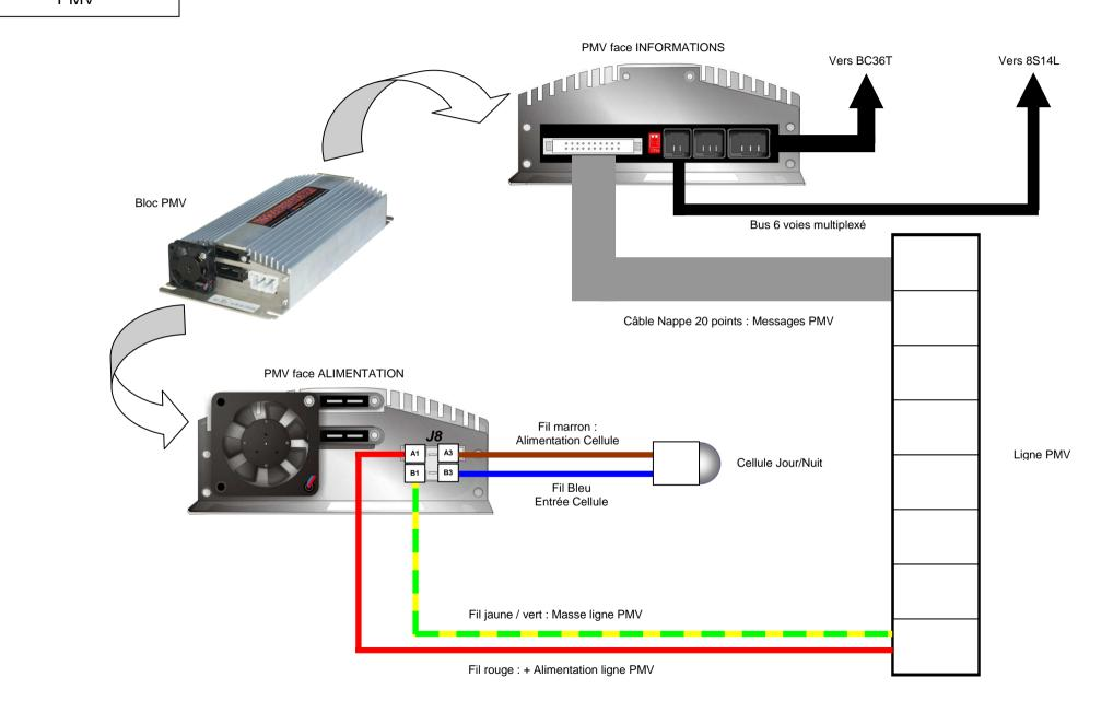
Le bloc PMV est situé dans le caisson, derrière la ligne PMV.
