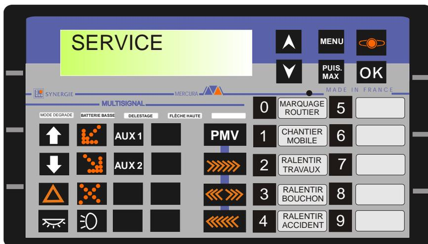
**NOTA:** Le boîtier de commande est rétro-éclairé automatiquement la nuit (commande par photodiode incorporée). L'appui sur une touche s'accompagne d'un bip sonore et de l'allumage de la led correspondante.
