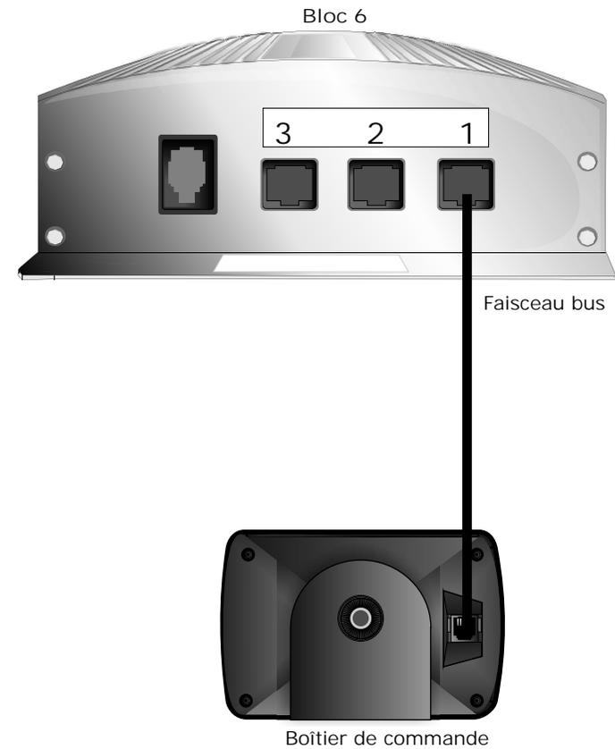
Nota: le câblage réseau du boîtier de commande doit s'effectuer sur l'entrée Bus n°1
