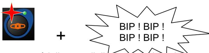
L'alarme sur une sortie permanente se matérialise par l'allumage de la led rouge de la touche MARCHE / ARRET du système et par une alarme sonore. Un cycle automatique de 4 séquences d'allumage de led et de séries de BIP s'effectue avant arrêt définitif de l'alarme sonore. La led rouge reste allumée, la ligne de puissance permanente située entre « A5 » et « B5 » du connecteur MIC 9 VOIES BLANC est sécurisée.
