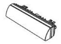
Les modules intérieurs orange ou bleus comportent 6 leds diffusant un faisceau de 20° vertical et de 100° horizontal.
