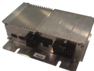
Le BLOC DE PUISSANCE CCS 446 EVO permet de commander et de protéger contre les courts-circuits jusqu'à 8 équipements électriques à travers 8 sorties de puissance et de commandes de 3A à 15 A. Il est possible également de piloter 2 sorties de commandes 1A et 4 sorties de 0,05A. Toutes ces sorties sont disponibles sur les connecteurs MCP 12 points et MCP 21 points.
