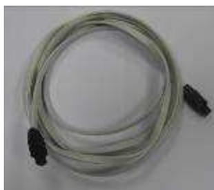
Un faisceau de réseau CAN peut se connecter sans importance sur l'une ou l'autre des embases 8 voies du bloc de puissance CCS 602.
