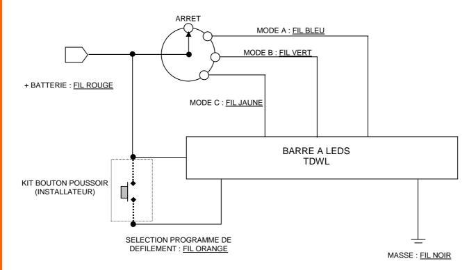
NOTA: Le COMMUTATEUR 4 POSITIONS et le KIT BOUTON-POUSSOIR ne sont pas fournis avec la barre à leds TDWL.
