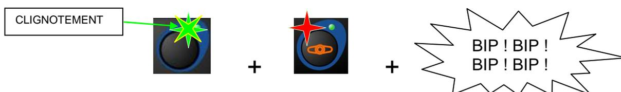
Pour acquitter l'alarme, il est nécessaire d'appuyer sur le bouton-poussoir associé à la led verte clignotante. La led verte s'éteint, la led rouge s'éteint également et l'alarme sonore s'arrête.
