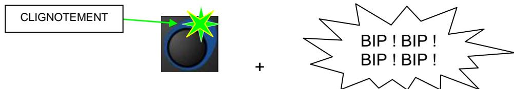
Pour acquitter l'alarme, il est nécessaire d'appuyer sur le bouton-poussoir associé à la led verte clignotante. La led verte s'éteint, la led rouge s'éteint également et l'alarme sonore s'arrête.
