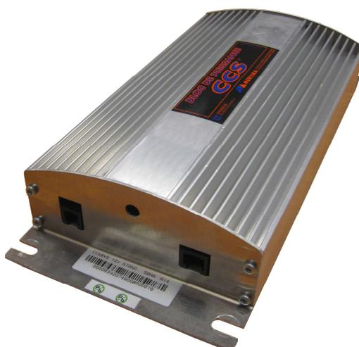
Le BLOC DE PUISSANCE 8 permet de commander et de protéger contre les courts-circuits, 8 équipements à travers 8 sorties de puissance disponibles sur 2 connecteurs MIC 13 voies noir et blanc.
