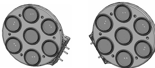
Feu d'alerte KR2 parabolique de 300mm à éclats de couleur orange, Classe F9M, composé de 7 feux LED de 74 mm assemblés dans cuvelage noir. La centrale clignotante est incorporée dans le feu. 2 feux peuvent être synchronisés. Différents modes de fixation sont possibles.
