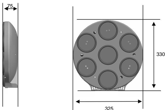
Points de fixation mécanique (Les vis de fixations ne sont pas fournies)
