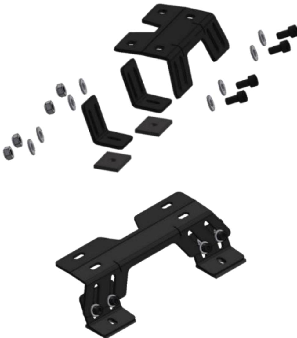
Pose des fixations sur socle
