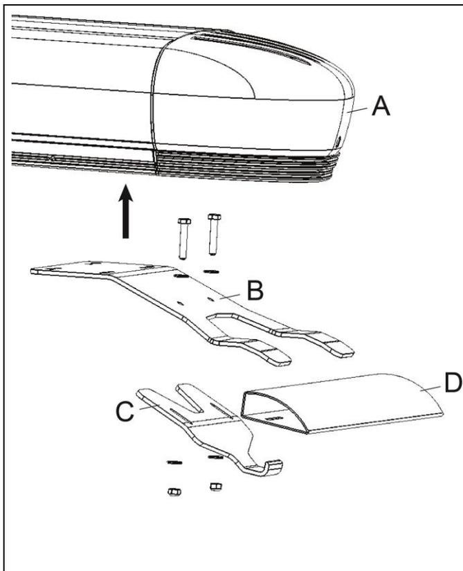
Fixer la rampe **A** (Différente selon modèle) sur les 4 points de la platine principale **B** à l'aide de la visserie fournie.
