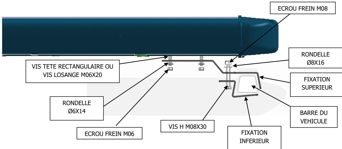
Pour ne pas abîmer les barres du véhicule, coller un morceau de feutrine sur les fixations.
