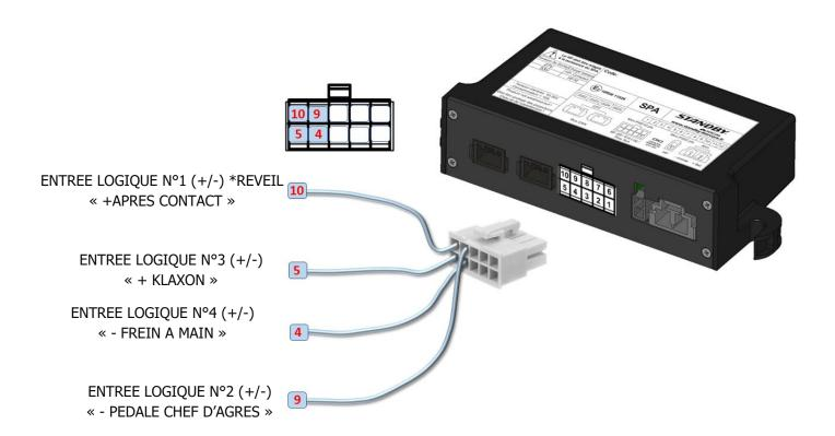
Les entrées logiques peuvent ne pas être câblées lorsqu'elles ne sont pas nécessaires. Le fonctionnement se fera alors via le boitier de commandes.
