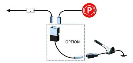
L'information frein à main serré est prélevée à travers un module frein à main qui permet d'envoyer une information de mise à la masse au système lorsque le frein à main est serré sans perturber le circuit du voyant « Frein à Main » tableau de bord.
