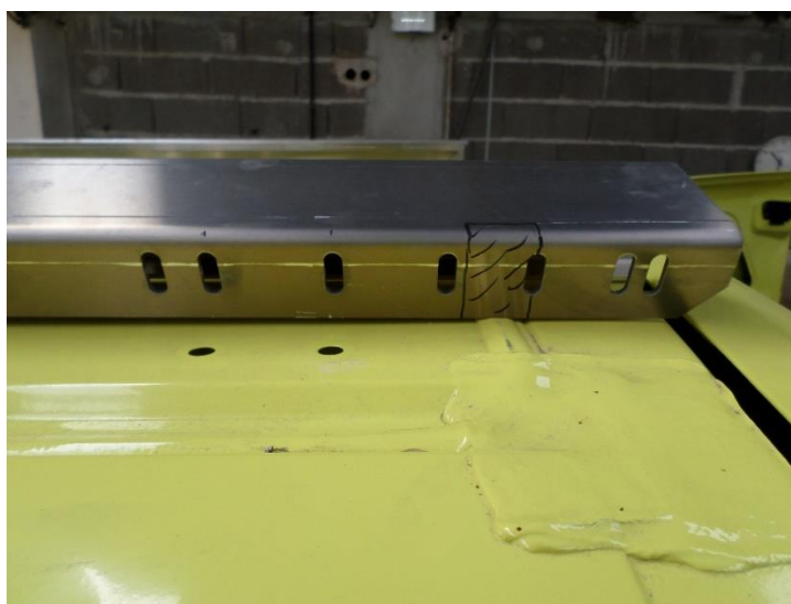
Figure 17. Suivant la proéminence du joint silicone, une découpe du profilé peut s'avérer nécessaire
