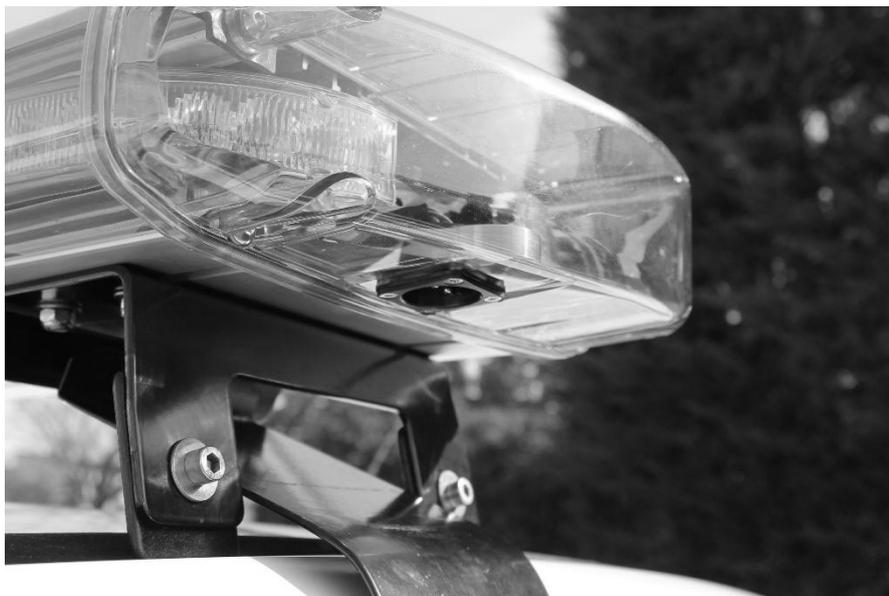
Ce modèle de rampe VEGA étant une rampe autonome sans fil, aucun câblage véhicule n'est nécessaire à ce niveau. Seule l'installation mécanique sur le pavillon du véhicule est à prévoir. Il existe différents types de fixation pour rampe VEGA.
