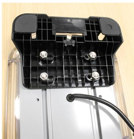
Utiliser du frein-filet et serrer les écrous.
