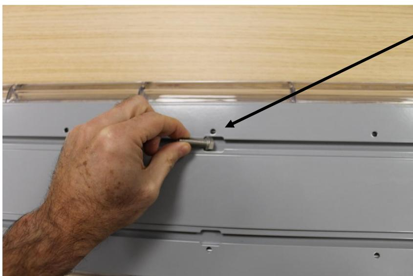
Insérez les vis hexagonales M8 dans les rainures prévues sur la plaque de base et serrez les écrous de manière à ce que le support puisse encore être déplacé pour l'ajustement.
