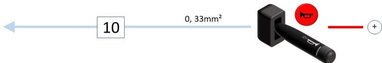
Il s'agit de prélever le signal « + BATTERIE » issue de la commande de l'après-contact du comodo klaxon.
