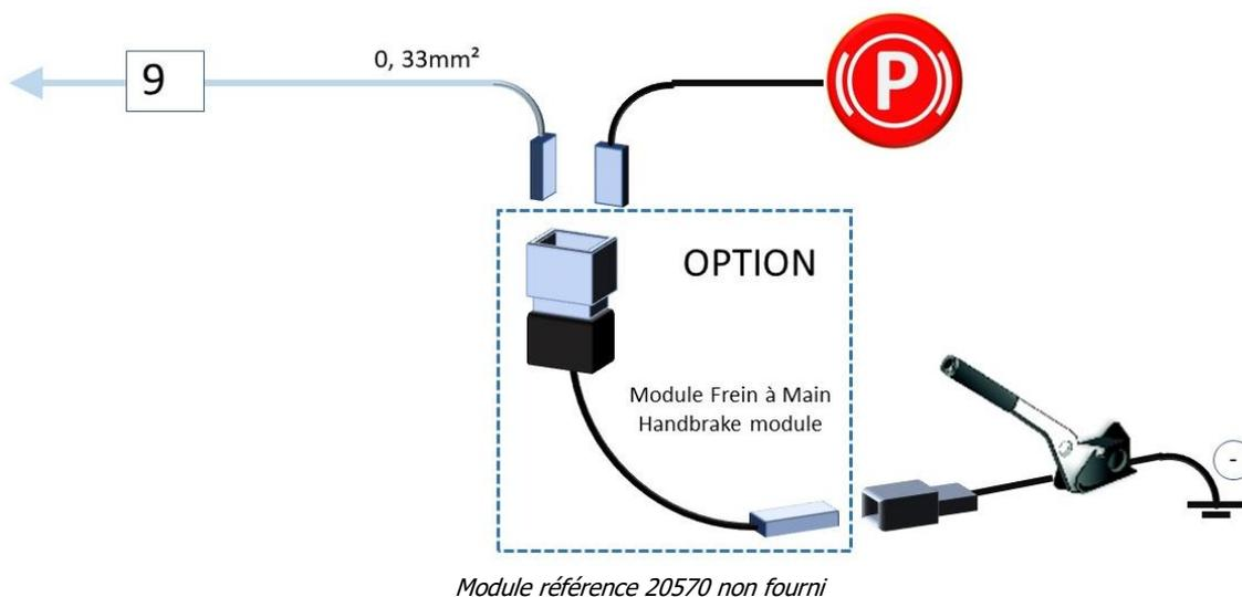
L'information frein à main serré est prélevée à travers un module frein à main qui permet d'envoyer une information de mise à la masse à la rampe lorsque le frein à main est serré sans perturber le circuit du voyant « Frein à Main » tableau de bord.
